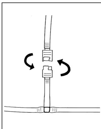
Для отсоединения расширяющей части ослабьте ее на шланговой муфте.
