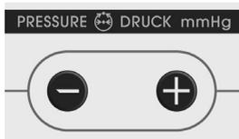
Ajuste de presión/indicación de presión 20-120 mmHg
