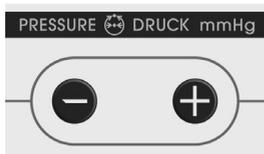
Регулировка/дисплей давления 20–120 мм рт. ст.
